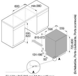
Für Höhe 817-819 mm Mutter entfernen Pour hauteur 817-819 mm enlever l'écrou Per l'altezza 817-819 mm rimuovere il dado
