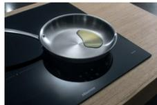
**Pot Recognition** – Nach dem Einschalten erkennt das Induktionskochfeld automatisch die Position des Topfes und wählt die Kochzone aus. Die Topferkennung erfolgt innerhalb der ersten 10 Sekunden nach dem Einschalten des Kochfeldes oder durch manuelles Aktivieren der Funktion.
